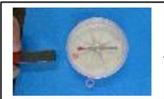
磁石のS極を近づけると、方位磁針のN極が向くのは、磁石と方位磁針の針が違う極だから。
